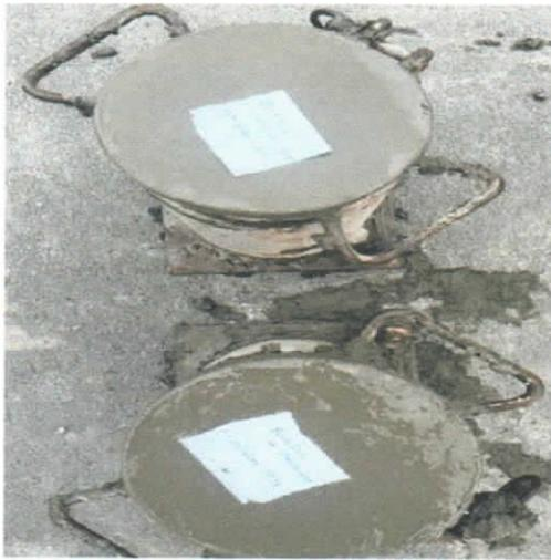
*Ilustración 9 Toma de muestras de hormigón para laboratorio*
